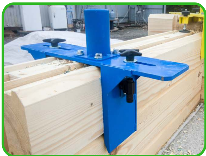
Оснастка «Скрытая электропроводка»
